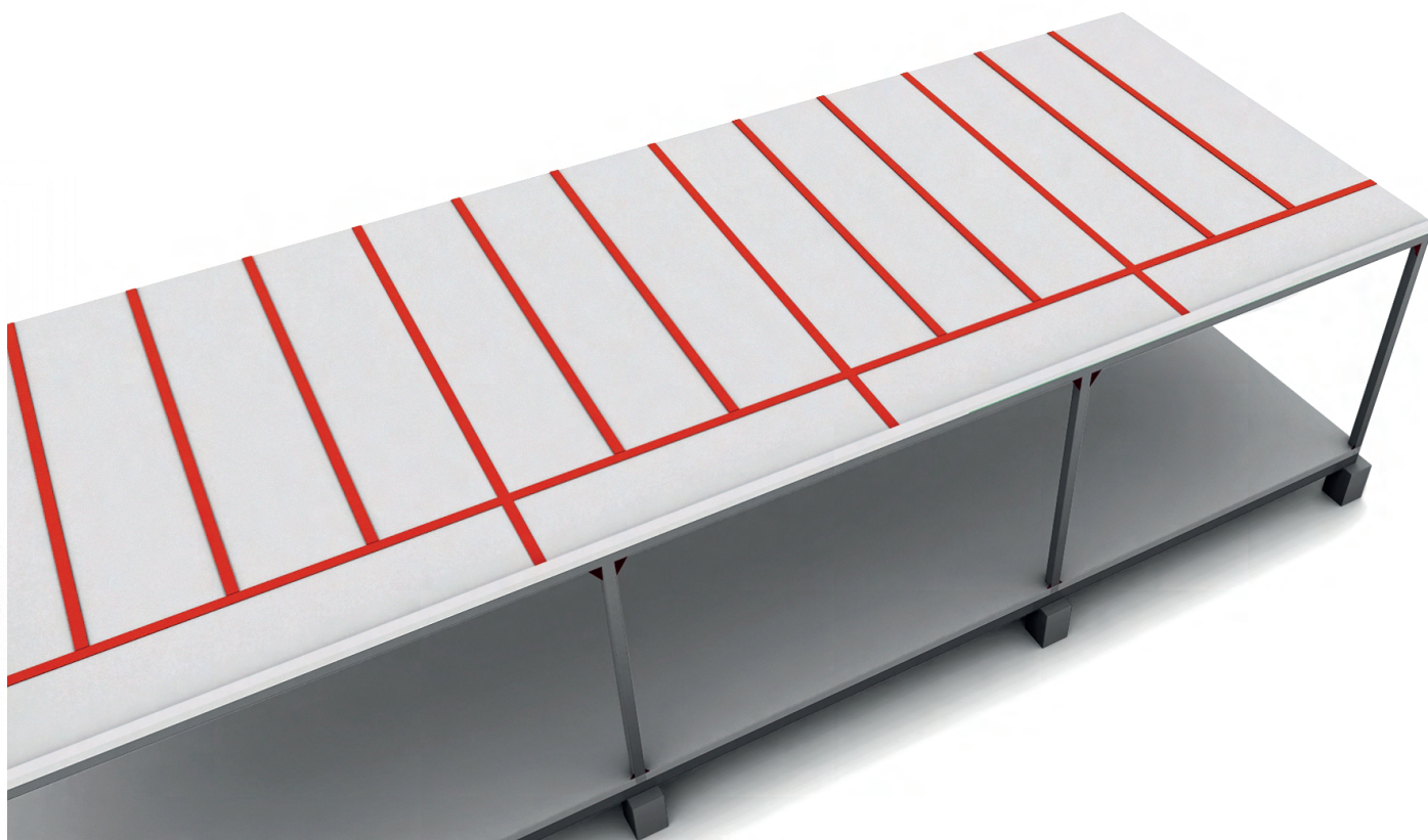
Detalle tratamiento de juntas en cubierta y detalle de pendiente
