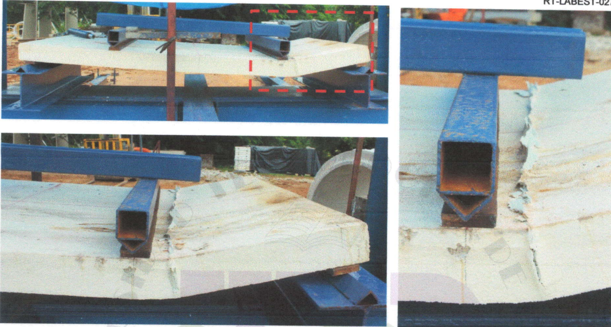
Figura 6.1 Falla del espécimen FLEX - 1,23 m - 01.
