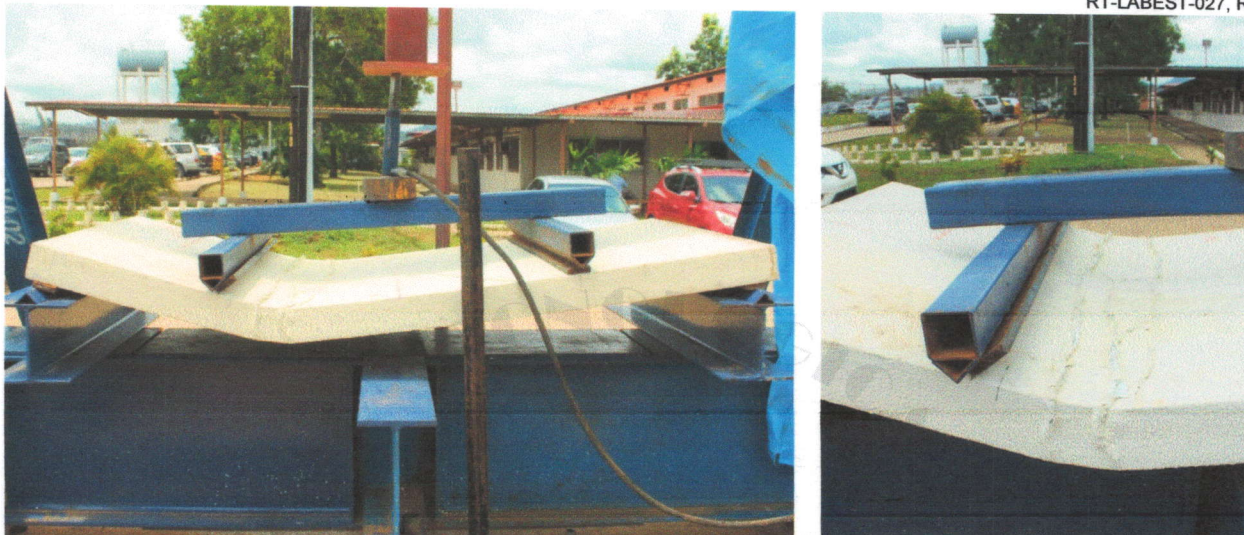
Figura 6.3 Falla del espécimen FLEX - 1,23 m - 03.
