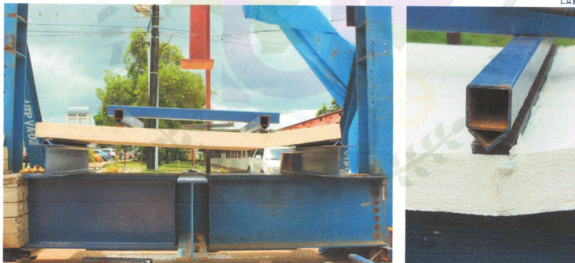
Figura 6.2 Falla del espécimen FLEX - 1,23 m - 02.
