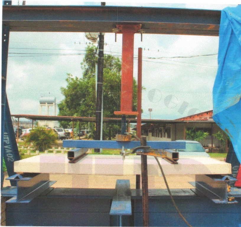
Figura 5.4 Vista lateral del ensayo a flexión (FLEX - 1,23 m - 03).
