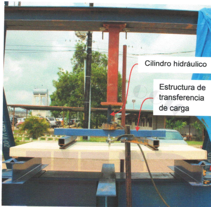
Figura 6.5 Espécimen FLEX - 1,23 m - 03 con instrumentación.
