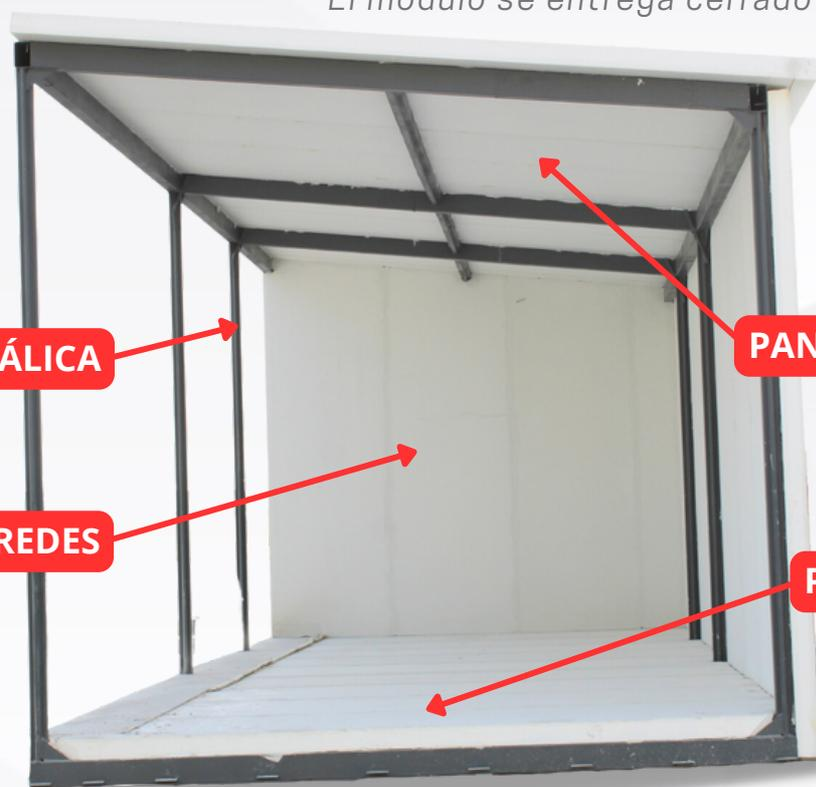
El sistema con el que se construyen todos nuestros módulos se basa en un esqueleto metálico, el cual es revestido con paneles sandwich de alta eficiencia energética (**quîckplâck**) hasta su completo cierre, y sus paredes fijadas y unidas a través de una mortero flexible (**quîckmôrtar**), una malla de fibra de vidrio (**quîckfiber**) y tornillería especial
