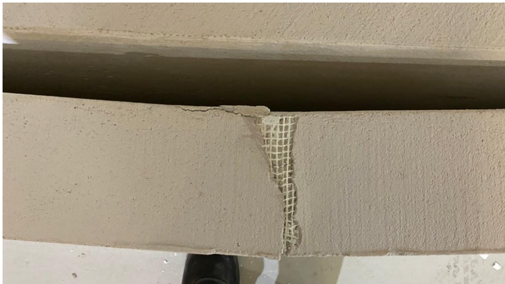
Fig. 3 Imagen del panel QUIPLACK donde se aprecia el modo de agotamiento
